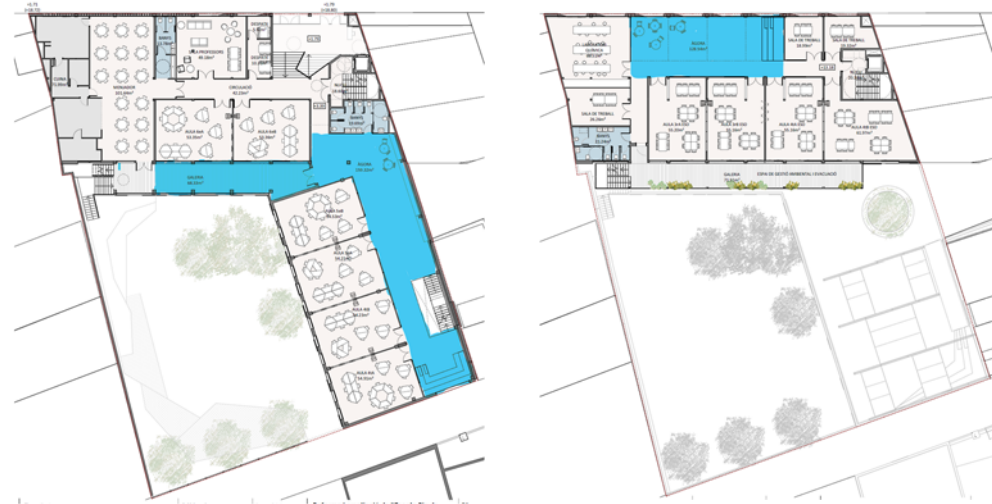
En blau, espais d'àgora en contacte amb les aules. A l'esquerra, exemple de planta primera. A la dreta, exemple de planta tercera
