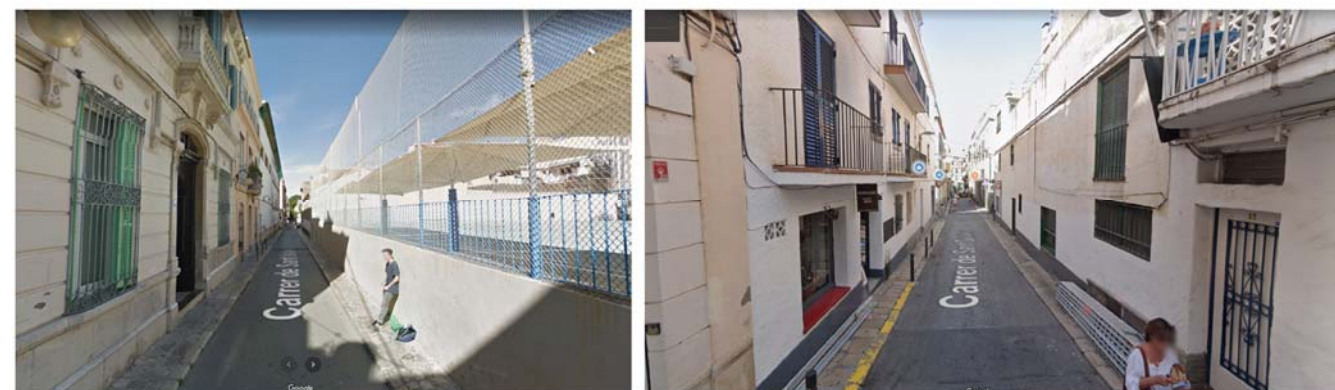
Exemple de la diferència de condicions d'asseïllament i amplitud visual del carrer segons la seva secció. A l'esquerra, imatge de la secció del carrer Sant Isidre al pas per l'Escola Pia. A la dreta, el mateix carrer amb les dues façanes edificades.
