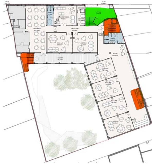
Esquema de la planta primera amb els nuclis d'escala en vermell, i el nou vestíbul d'accés des del carrer Hort Gran en verd.
