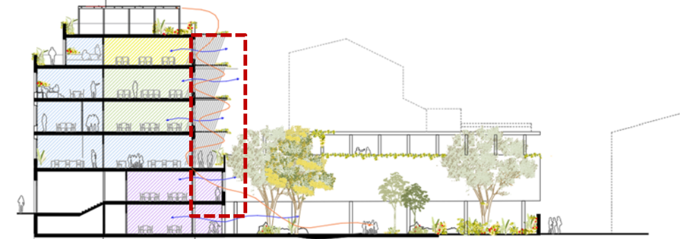
Secció amb les passeres que estenen el paviment a través la façana sud
