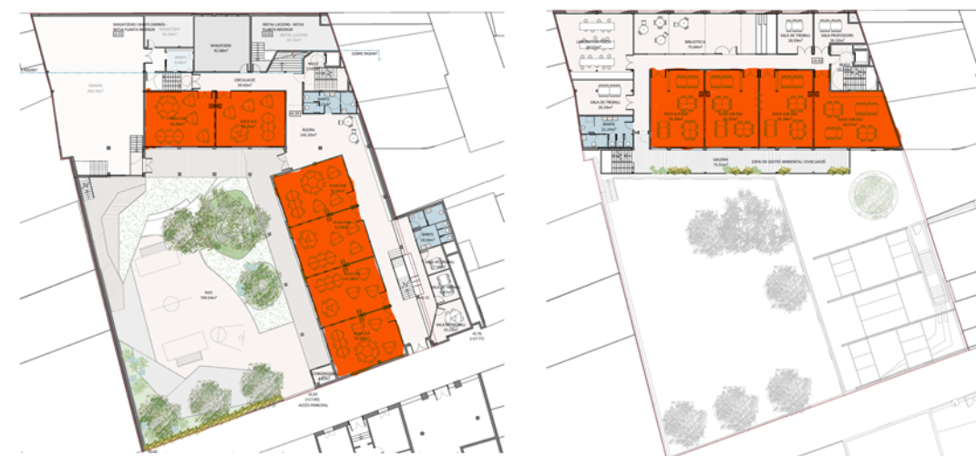
Esquema de la nova disposició de les aules de tutoria (en vermell) obertes al pati i a sud. A l'esquerra, planta baixa, a la dreta, planta tercera
